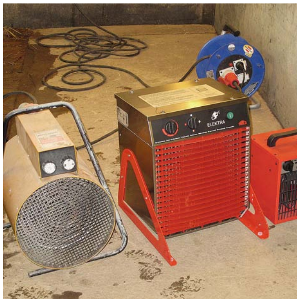
Tre olika fläkttyper. Den vänstra och högra uppfyller inte kriterierna för användning i häststallar.
