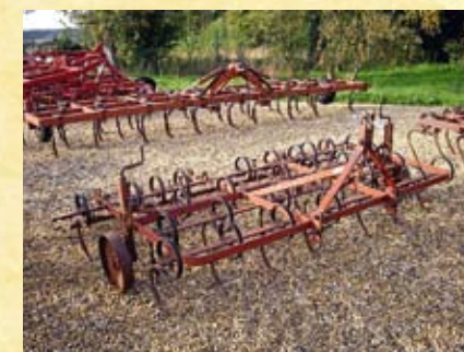
Kongskilde var tidigt ute med harvar där höjdregering skedde på ett sådant sätt att pinnarna inte behövde vinklas. FOTO: PER FRANKELIUS
