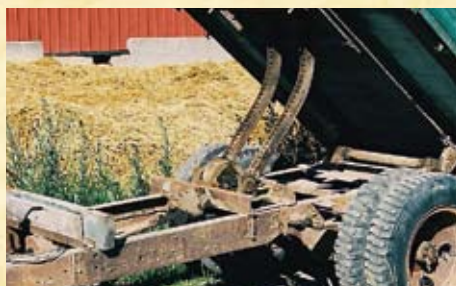
Mekaniska tippmekanismer drivna av traktorns kraftuttag var en innovation.
