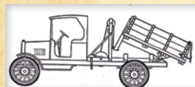
Robert T. Mawhinney uppfann "Dump box for truck". Mellan förarplats och flak fanns en mast. Över en trissa i dess topp löpte en lina till en vinsch. I andra änden var den fäst i stång monterad på flaket.
