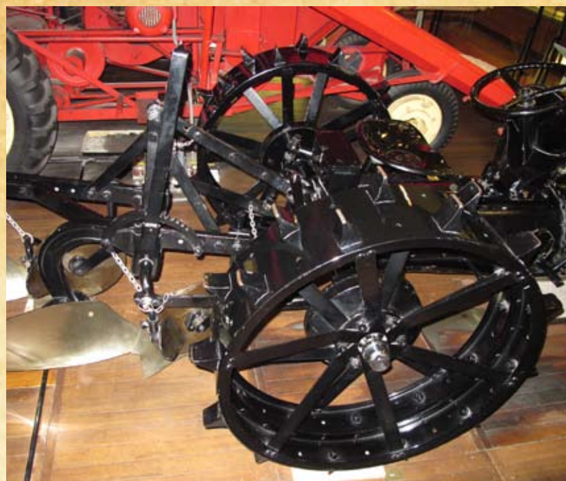
Här är Ferguson Black med plog från 1933. Den hade en Herculesmotor. Växellåda och transmission kom från David Brown. Framför allt hade den trepunktslyft. Traktorn finns i dag på Science Museum i London omgiven av pansarglas.
